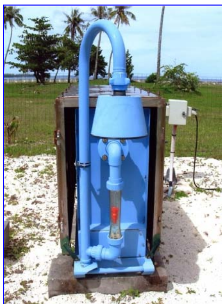
Appareils de prélèvement des aérosols en zone Martine (type CASA 110)
