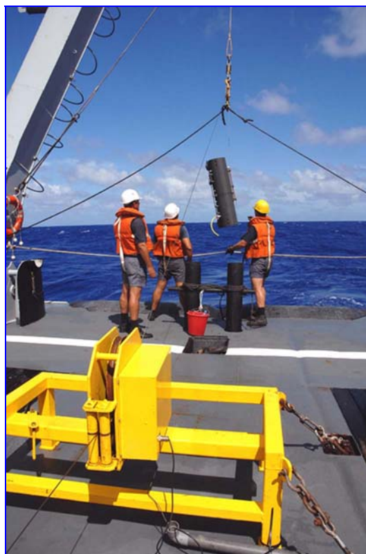
Prélèvement d'eaux océaniques effectué à l'aide d'une bouteille « General Oceanic » de 60 litres.
