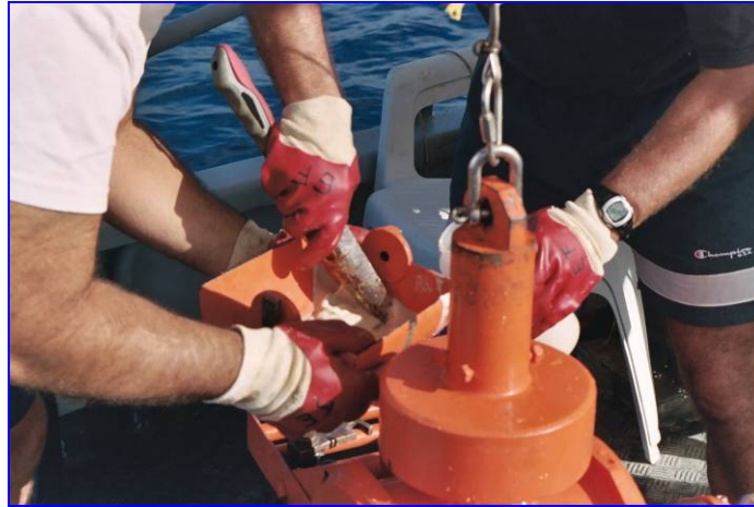
Récupération des sédiments dans le godet de la benne Shipeck.
