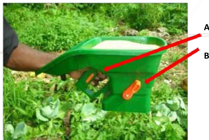
Modèle type d'épardeur à main, illustrant la manivelle (a) l'ouverture réglable (b) et la façon correcte de le prendre en main. Régler l'ouverture sur 1.
