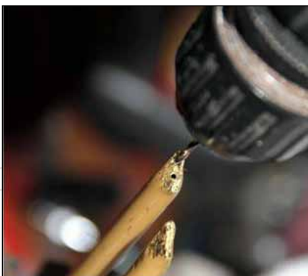
On peut éventuellement y percer deux petits trous.
