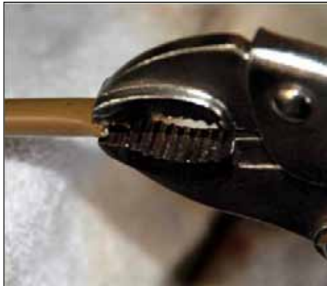
Pincer l'extrémité avec une pince pour la fermer presque complètement
