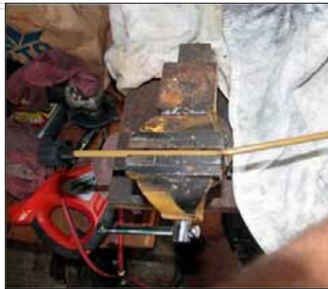
Maintenir la lance dans un étau et plier jusqu'à ce qu'elle claque
