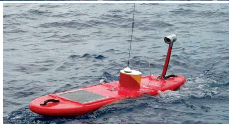
Figure 78 : en haut, drone de surface eFolaga (source : Maguer et al. 2013), en bas Wave Glider Liquid Robotic (source : Manley 2008).
