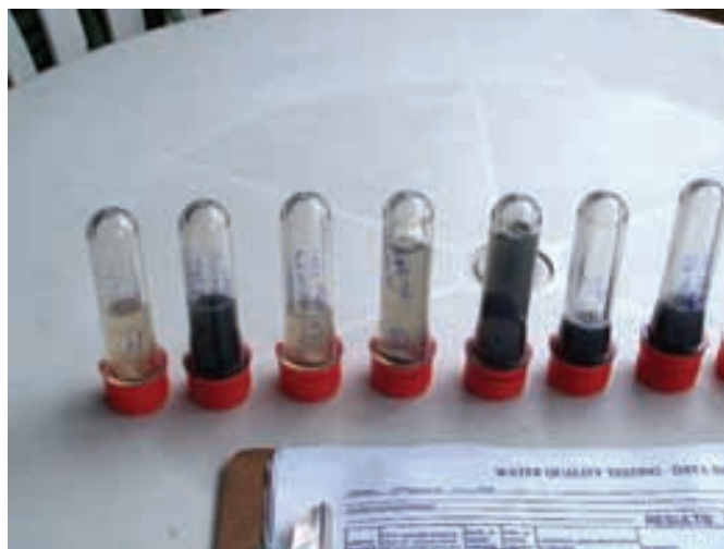
E so na sabolo ni wai ka vakadikevi ena H_2S Test
