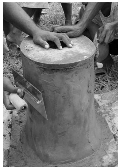
28. Applae seken 5 mm smen leia. Raonem long top mo botom blong hemi level wetem ol edj blong mold.
