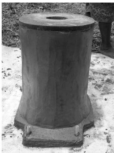
29. Afta 30 minit, rimuvum mold blong botom mo smutum ol edj. Livim 1 dei afta rimuvum mold blong antap.
