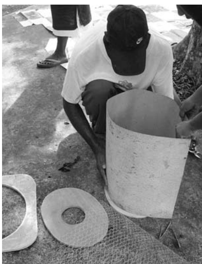
21. Benem flat aean raon long insaed tip long 2 leia mold.
